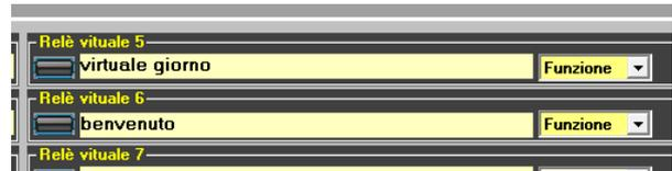
Innanzitutto colleghiamo l’ingresso che abbiamo chiamato **sensore giorno** al relè **virtuale giorno** in modalità passo-passo facendogli generare un evento. Ovviamente se si trattasse di un vero sensore non potremmo collegarlo in modo passo-passo; usiamo, in questo esercizio, questo tipo di collegamento solo per comodità.
